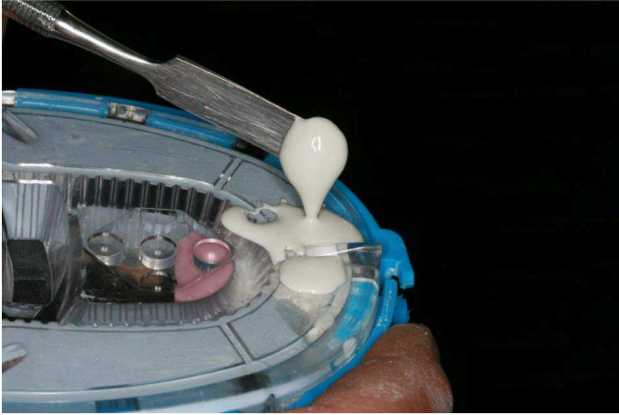
Vertido de material refractario.
